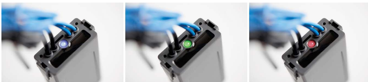
Led lampica na dekoderu za indicaciju statusa (aktivno, kratki spoj, dijagnostika, povezivanje sa stanicama)
